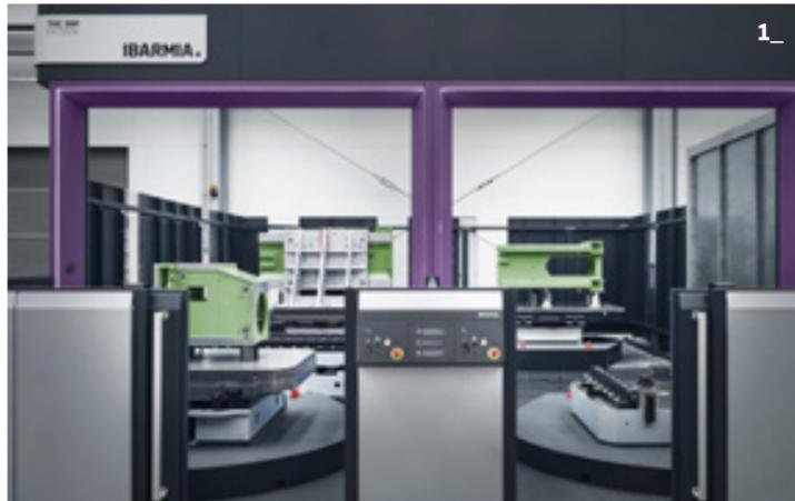
1\_ Sobre estas líneas, un cambiador automático de pallets de cuatro puestos sobre una THC 30 EXTREME (modelo con capacidad para volteos de hasta  $\varnothing 3000$  mm sobre piezas de hasta 1950 mm de alto y 20 t de peso). Estos puestos giratorios permiten cargar y descargar piezas mientras la máquina está en funcionamiento (2 y 3), eliminando así los tiempos de inactividad causados por la compleja preparación que este tipo de piezas de gran volumen requieren (ver página 21).
