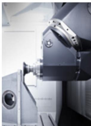
THC I CABEZAL EJE B
